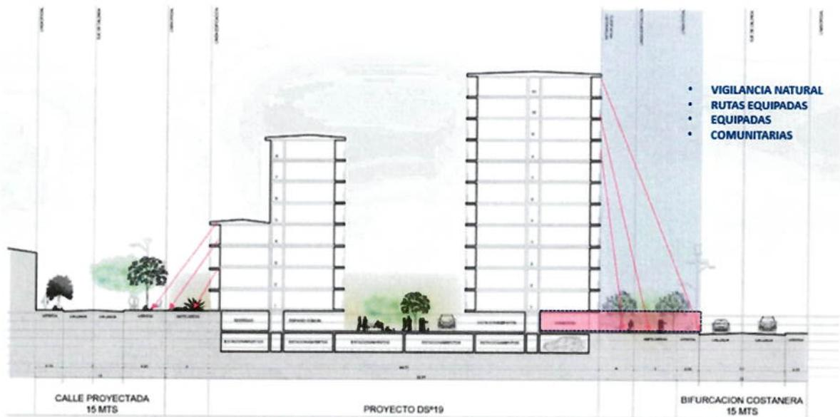
Figura N° 5: Diseño referencial para la separación, distanciamiento y orientación entre edificaciones en altura (Anexo 1).
